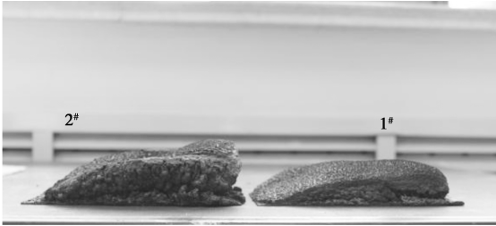
图 2 热衰减样板与标准样板膨胀炭层对比
